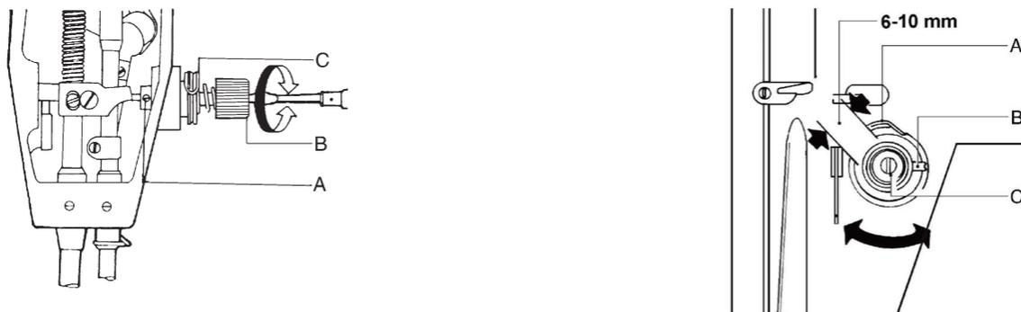
Шаг нитепритягивателя составляет 6 мм - 10 мм, при шитье тонкой ткани, снизьте натяжение нитепритягивателя и увеличьте шаг нитепритягивателя, а при шитье очень толстой ткани, увеличьте натяжение нитепритягивателя и уменьшите шаг нитепритягивателя.
